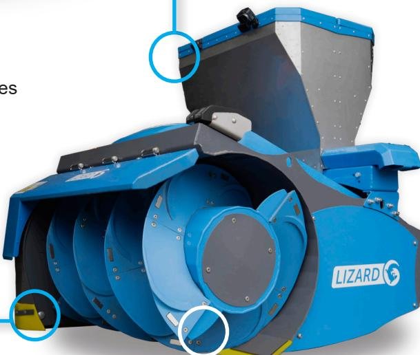
Tornillo modular patentado con imanes: hecho de plástico especial; fácil reemplazo de módulos desgastados que están diseñados para maximizar la seguridad alrededor del robot y aumentar la aireación del alimento
