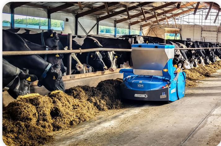
🇪🇸 EM LIZARD es accionado por motores sin escobillas BLDC a través de engranajes planetarios para un funcionamiento sin mantenimiento. La mayor ventaja es un tornillo modular hecho de plásticos altamente resistentes a la abrasión. El diseño patentado del tornillo modular permitió dar forma a cada módulo, gracias a lo cual el alimento no solo se desplaza hacia las vacas, sino que está perfectamente aireado.
