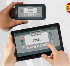
Una aplicación móvil que transfiere el control del indicador de peso a un dispositivo móvil; sólo se puede conectar y controlar un indicador de peso
