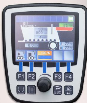
Control electrónico de avance de la cinta, funciones hidráulicas, dedicadas a funciones más extensas, es decir, sistemas de pesaje y esparcido preciso
